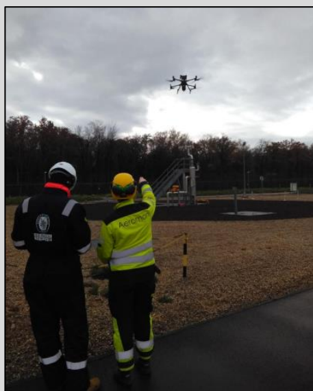
Photo 2 : cartographie des émissions site via drone / capteur
